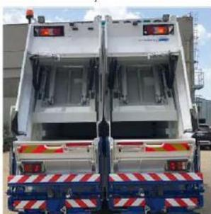
Camión con dos compartimentos para la recogida simultánea de dos fracciones diferentes de residuos.
